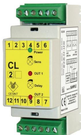
CL-2 señala el nivel del líquido de un depósito controlando la conductividad entre dos electrodos instalados en el depósito al que se quiere controlar el nivel y un electrodo común de referencia. Cuando los electrodos entran en contacto con el líquido hay un paso de corriente que provoca la intervención del instrumento. La tensión entre los electrodos es de tipo alterna para evitar fenómenos de electrólisis en el líquido y de corrosión de los electrodos.
