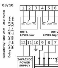
El interruptor de nivel CL-2 puede controlar dos electrodos de nivel de un modo independiente, verificando la conductividad con un electrodo de referencia común. Cada uno de los electrodos tiene asociado un relé de salida.
